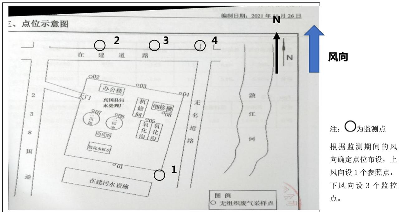
图2 无组织排放废气监测布点示意图
